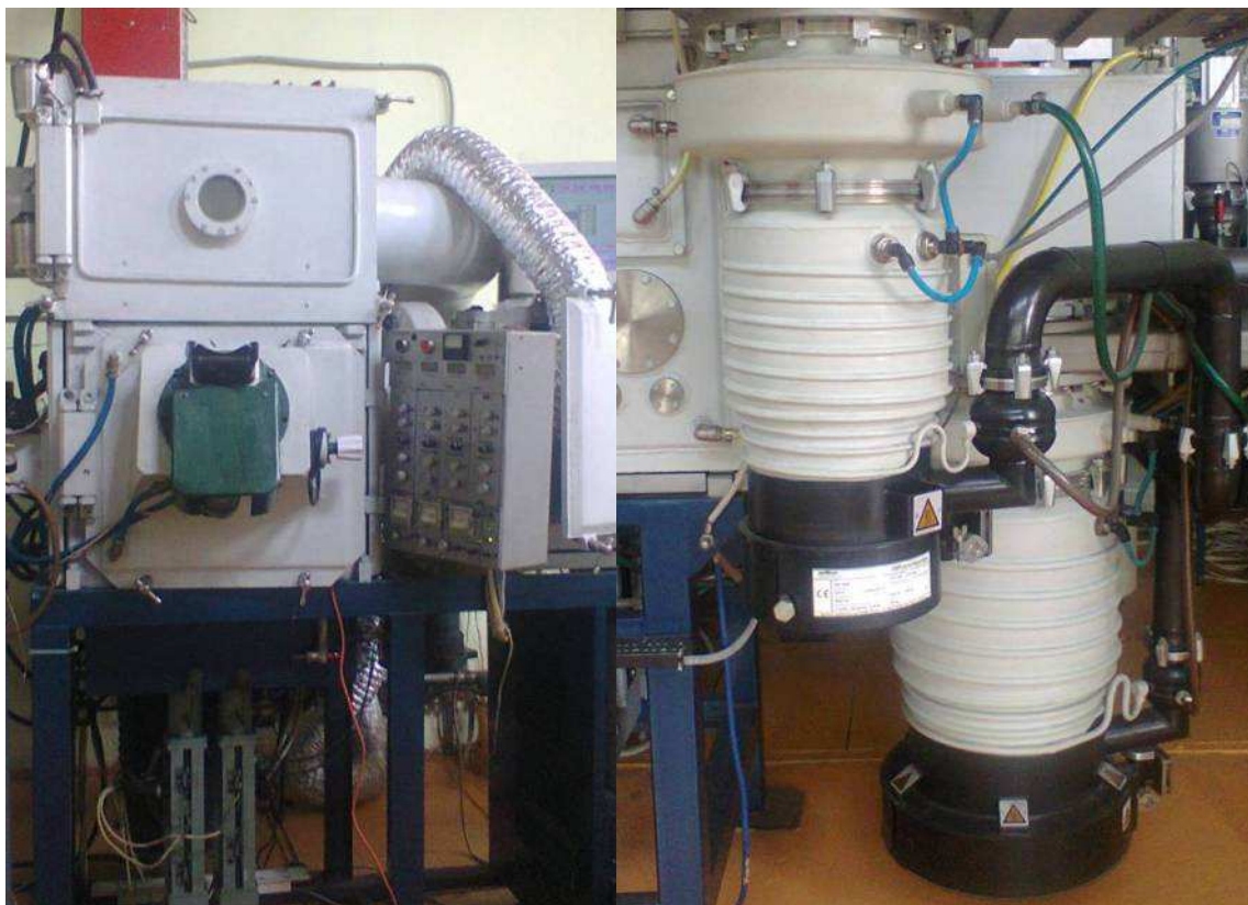
Рис. 1. Установа для виготовлення мультифольг методом електронно-променевого випаровування: а) вакуумна камера, б) вакуумні насоси
