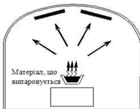
Рис.2.1.1 Схематичне представлення системи термічного нанесення. При термічному нагріванні через човник пропускається струм що нагріває із склом до потрібної температури.
